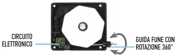
Sensore a fune per tapparella con innovativo interruttore elettronico piezoelettrico (**brevetto Duevi**) che apre l'uscita in modo pulito e regolare senza rimbalzi meccanici, con un impulso di apertura di circa 7ms. Questa tecnologia migliora il conteggio impulsi ed evita tutte quelle criticità tipiche del modello meccanico: mancati allarmi, apertura permanente del contatto per scivolamento o dilatazione termica, ossidazione del contatto.
