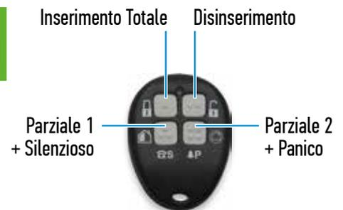
Un pulsante per inserimento totale, un pulsante per disinserimento. 2 pulsanti per 2 inserimenti parziali o funzioni allarme silenzioso e panico. Alimentazione batteria 3V CR2032 (inclusa). Compatibile con centrali mod. CE33 | CE60 | CE100.
