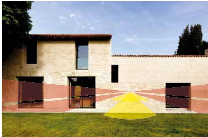
MOSKITO+ è un sensore che protegge il perimetro dell'edificio con un'efficacia mai vista prima. La rilevazione è affidata alla combinazione di ben sei testine ad infrarosso passivo, disposti su tre lati, ciascuno con propria regolazione della sensibilità. Può essere montato ad un'altezza di 1,00m / 1,40m.
