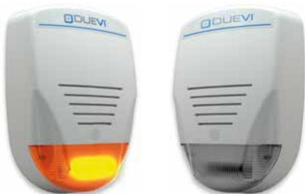
Sirene da esterno dal design gradevole e discreto. Flash led alta luminosità con segnalazione attivazione e disattivazione impianto. Protezione tamper antiapertura/antiasportazione. Schermo metallico interno antisciuma. Contenitore in ABS e policarbonato bianco. Dimensioni circa 310x210x85mm.
