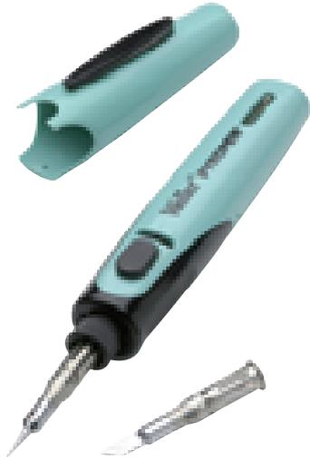
Il nuovo WP 60 integra 3 differenti funzioni: saldatura, gas inerte e brasatura. Funziona con bombolette di gas butano con operatività di circa 60 minuti. Utensile ergonomico, compatto, leggero e portatile con cappuccio di protezione e poggia-stilo. La temperatura può essere regolata in base al tipo di funzione per un massimo di 1300° C per la brasatura, 500° C per la saldatura e 700° C per il gas inerte.
