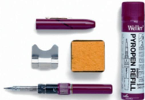
Ministilo per saldature e brasature con controllo della temperatura. Si ricarica in pochi secondi. Non richiede alcun cavo di alimentazione né batterie ed è completamente esente da scariche elettrostatiche (nessun picco). Le punte saldanti Longlife si riscaldano rapidamente. Controllo della temperatura: 200-450°C. Funzione aria calda: 430°C max. Funzione cannello: 1300°C max.
