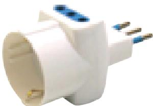
Adattatore triplo multistandard. Spina standard italiano 2P+T 16A. Due prese con alveoli schermati standard italiano 2P+T 10A. Una presa frontale con alveoli schermati Standard tedesco 2P+T laterale e centrale 16A
