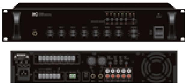
Amplificatori 5 Zone da 60W/120W/240W con 3 ingressi microfonici, 2 ingressi aux e 1 ingresso EMC. Funzione muting tramite ingresso EMC con priorità sugli altri ingressi tranne Mic1. Controlli di guadagno individuali sono previsti per: Mic 1-3, Aux 1-2, bassi e alti. Uscite 70V, 100V e 4-16Ω. Ampia protezione da cortocircuito, sovraccarico e alte temperature.
