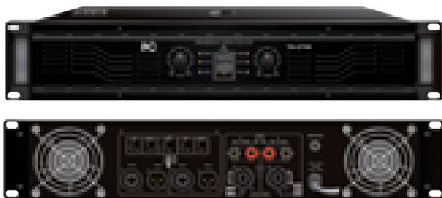
Amplificatore Stereo 2x 700W 2-4-8Ω (700W a 8Ω) con pannello in acciaio. Design professionale con superficie resistente, prese d'aria di raffreddamento rimovibili per la pulizia. Accensione soft start per evitare picchi di assorbimento in fase di accensione e creare interferenza con altri apparecchi connessi alla rete. Raffreddamento a controllo forzato, basso rumore della ventola e ad alta efficienza termica.
