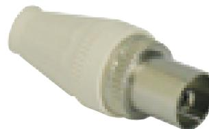
Manicotto in materiale termoplastico, boccola in ottone nichelato, semiguscio in acciaio, fissaggio cavo a vite, impedenza 75 Ohm.
