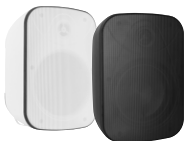
GS-600 Diffusore a roccia colore grigio 30W 8Ω Trasformatore 100V, da interno/esterno (IP65) Potenza nom: 30W; musicale: 70W
