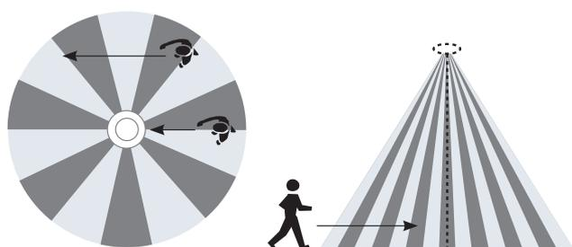
Il riconoscimento massimo del movimento avviene quando si attraversa il rilevatore trasversalmente, non quando ci si avvicina frontalmente. Questo aspetto deve essere tenuto in considerazione soprattutto per i corridoi.
